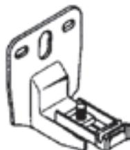
Consoles murales (11) (réglables) avec profil en nylon. Galvanisé standard. distance min. du mur 45 mm., distance max. du mur 65 mm.
