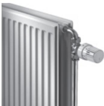
Le **radiateur Standard** existe en 6 exécutions, du radiateur à un 1 panneau sans convecteur au radiateur à 3 panneaux avec 3 convecteurs (pattes soudées comp.). Grâce aux raccords 4 x 1/2", ce modèle convient aussi bien pour les systèmes à 1 qu'à 2 tuyaux. Le radiateur Standard est livré en couleur standard blanc (RAL 9010).
